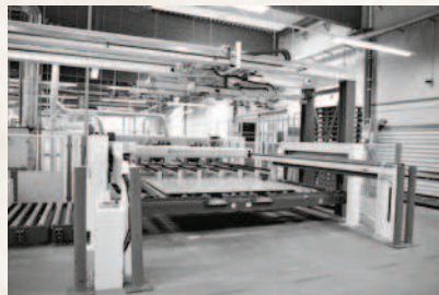
Die Plattensäge verarbeitet auch Groß- und Sonderformate und wird direkt mit dem Stapler beschickt.
